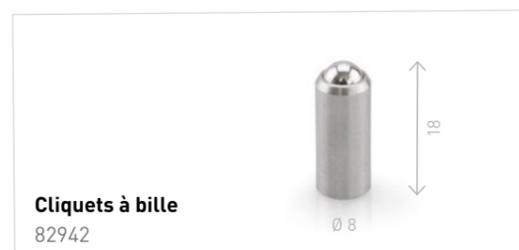
Grâce à un ressort métallique installé en-dessous de la bille, les panneaux latéraux ou arrière peuvent tout simplement être « encliquetés ». Ainsi, le système de fixation est invisible de l'extérieur et de l'intérieur.
